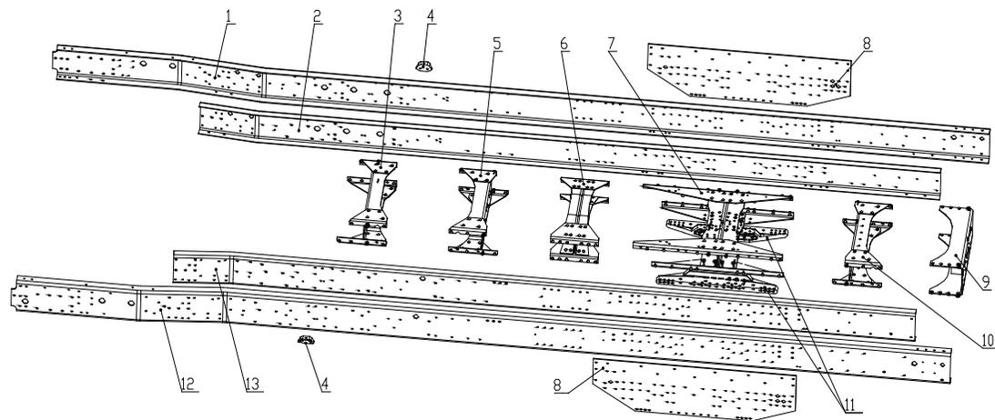
CJ06C 6×4 载货车车架
