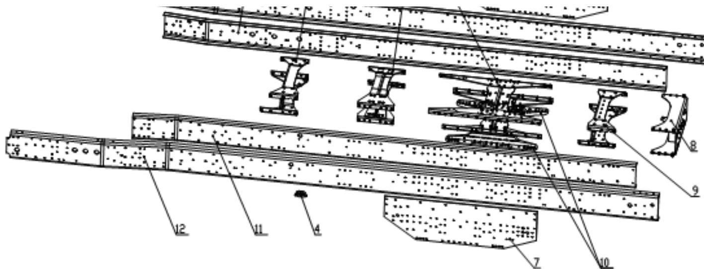
6×4载货车车架CJ06A
